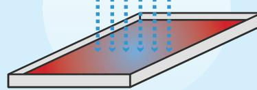
高温の酸化スラグをスラグパンに移し、水シャワーで冷却し、固めます。冷却後スラグを愛知県弥富市の本社工場へ運搬します。
